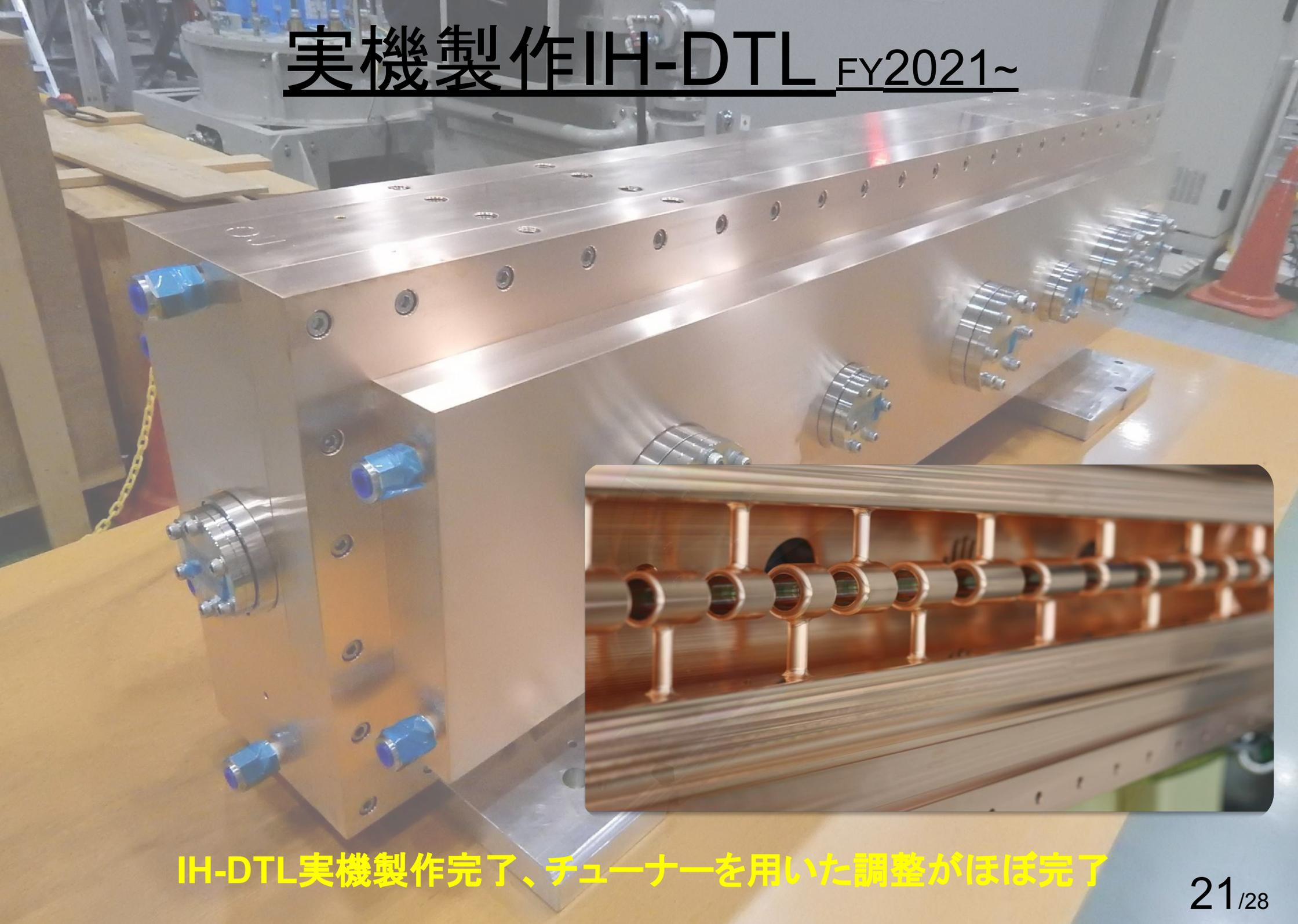
IH-DTL実機製作完了、チューナーを用いた調整がほぼ完了
