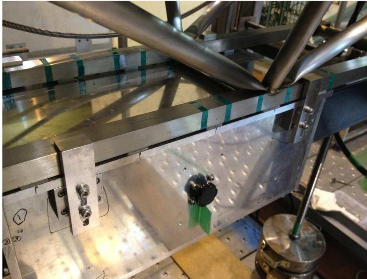
インストールジグとTOPカウンタ(ストロングバック)を切り離す時の衝撃防止用にL金具を取付け
