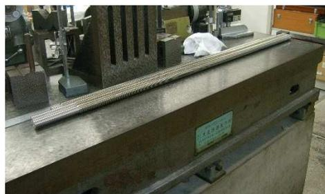
送りネジ旋盤加工
